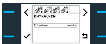
Im i-Menü können unter dem Reiter **Dosiertechnik** die Entkalkungszeit und -temperatur angepasst werden.
