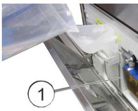
5. Chemie mit Hilfe des Trichters vorsichtig in die Maschine füllen, bis der Vorratsbehälter voll ist. Füllstand über das Füllstandsfenster (1) prüfen.
