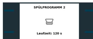
Nach einem Wechsel des Spülprogramms wird nach ca. 3 Sekunden die Laufzeit kurz angezeigt. Dadurch kann die richtige Wahl des erforderlichen Spülprogramms überprüft werden.
